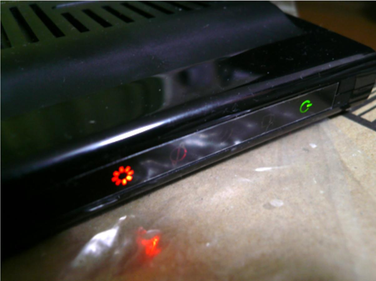
※バーが 100%かつ DIAG LED が消灯後、WHR-G301N に接続している LAN ケーブルを WHR-G301N の WAN 側に差し替えます。(電源は切らないで下さい。)
